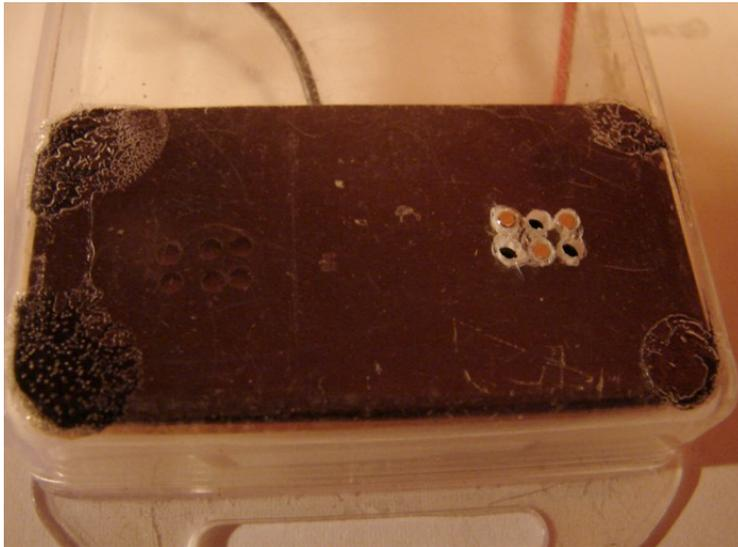
**Макет тактильной ячейки с выдвинутыми тактильными элементами**
