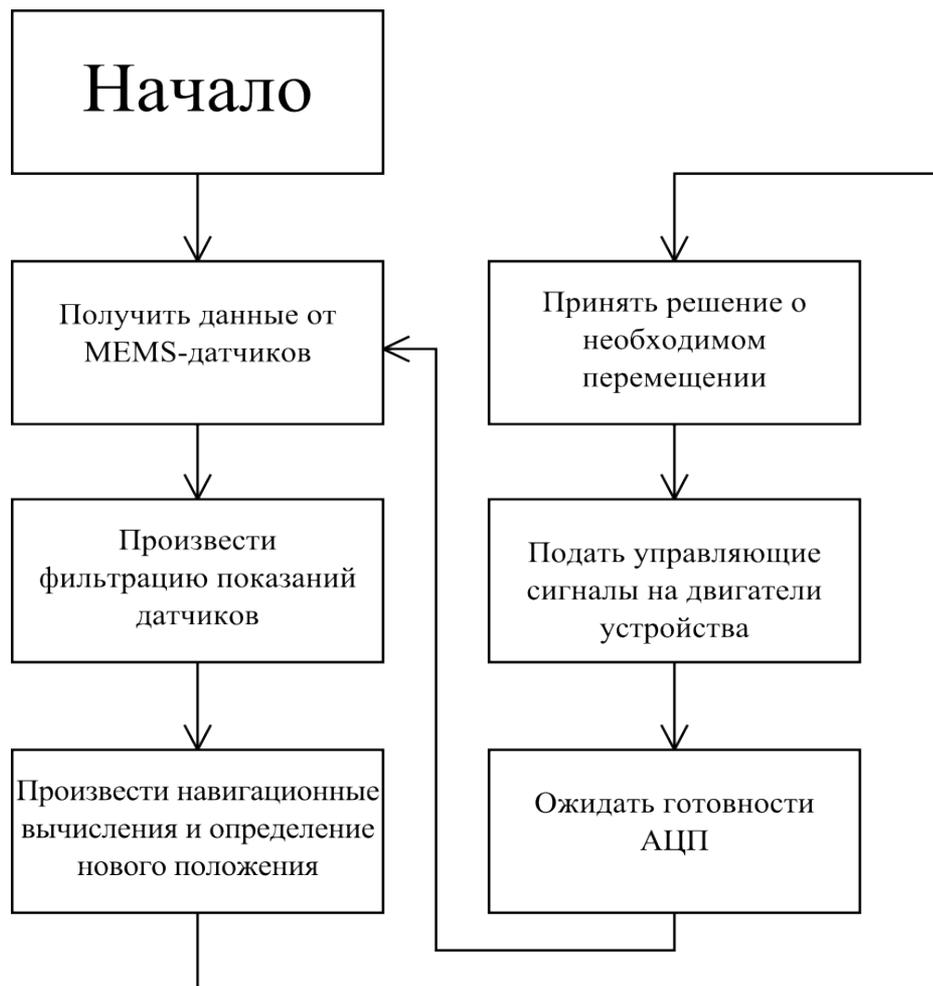
Производительность АЦП AD7799 позволяет производить измерение выходного значения каждого датчика как минимум 20 раз в секунду.
