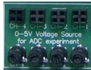
Источник опорного напряжения
