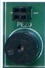
Пьезо динамик резонансная частота от 2 до 3 кГц
