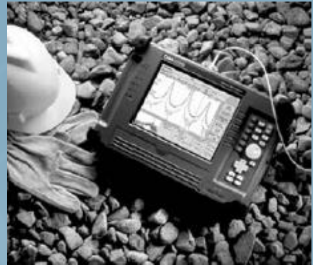
Анализатор СМА-4791 для диапазона 1520-1620 нм на базе фильтра Фабри-Перо
