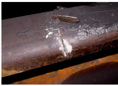
Поперечный пропил в головке рельса
