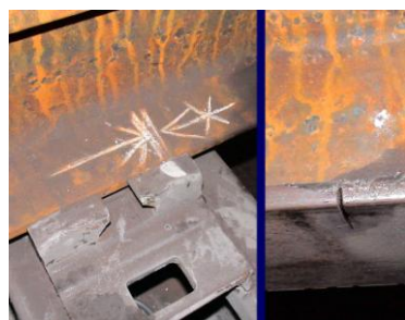
Рельс, лежащий на опоре, с поперечным пропилом в подошве
