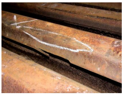
Продольная трещина в головке
