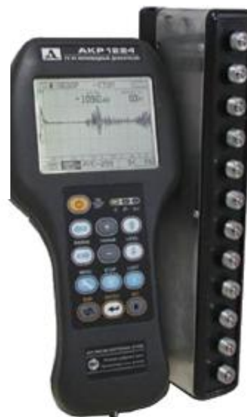
Ультразвуковой дефектоскоп для контроля рельсов АКР1224
