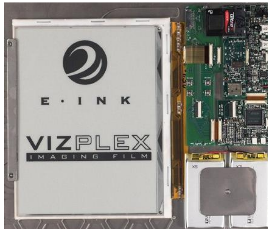
Электронная бумага на базе контроллера SID13521B.
