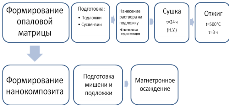
Получение опалового нанокompозита методом магнетронного напыления
