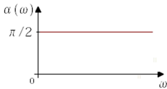
Рисунок 7 - ФЧХ идеального дифференцирующего устройства
