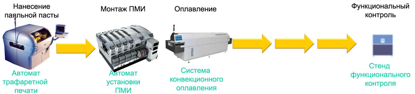
Рисунок 2.5.1.1 – Схема технологического процесса сборки печатных узлов без систем контроля и инспекции
