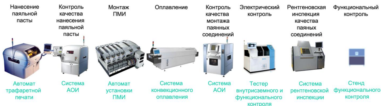
Рисунок 2.5.1.4 – Схема технологического процесса сборки печатных узлов при внедрении современных автоматических систем инспекции и контроля
