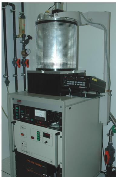
Установка термического вакуумного напыления
