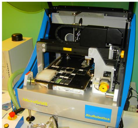
Установка для нанесения ДНК зондов
