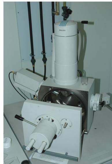
Сканирующий электронный микроскоп
