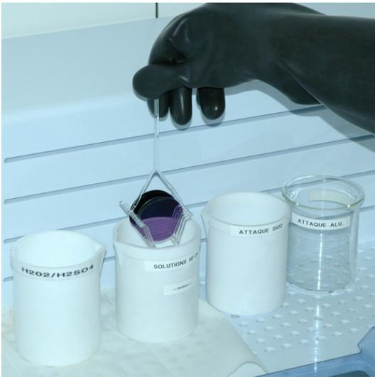
Очистка пластины в плавиковой кислоте
