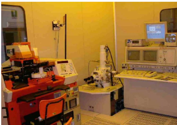
Установка оптической литографии и сканирующий электронный микроскоп
