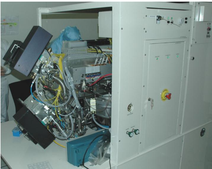
Установка ионной имплантации
