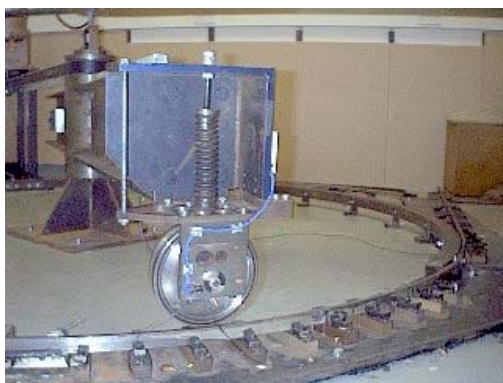
Модель системы активного снижения вибраций колеса.
