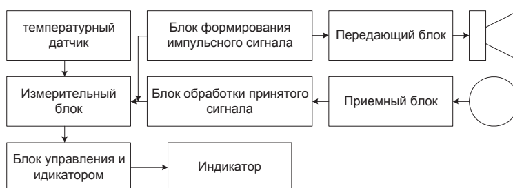
Рис. 3. Обобщенная структурная схема ультразвукового дальномера
