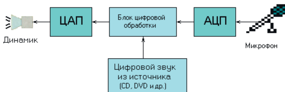
Рис.1.Обобщённая схема формирования цифрового звука.
