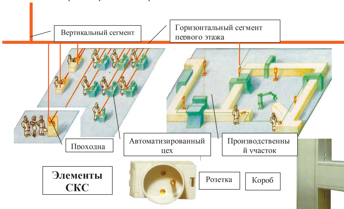
Рис.1. Сетевая инфраструктура современного производства в рамках CALS технологий.
