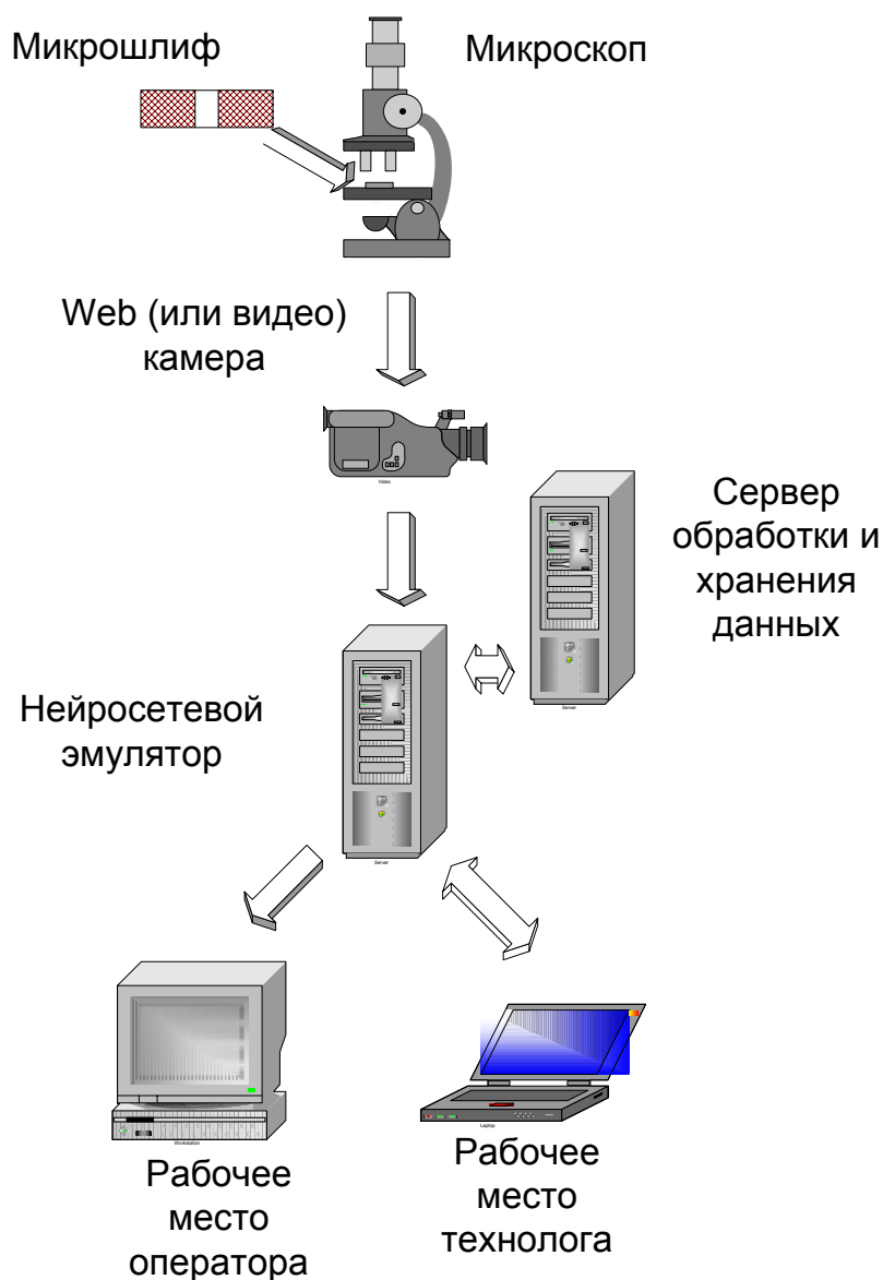
Рис.4. Структурная схема и последовательность работы «нейросетевого аппаратно-программного комплекса».
