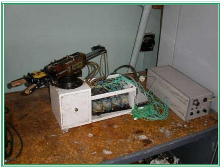
Рис.13. Внешний вид исполнительного устройства – робот МП-9С.
