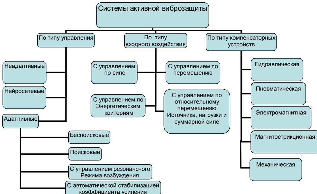
Рис.1. Классификация систем активной виброзащиты
