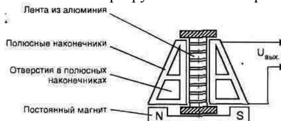
Рис. 4. Электродинамический ленточный микрофон.
