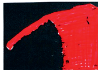
Рис. 11. Подтравливание проводящего рисунка
