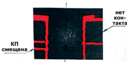
Рис. 5. Дефекты металлизации стенок отверстия
