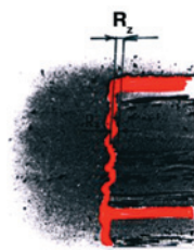
Рис. 3. Шероховатость стенок отверстий
