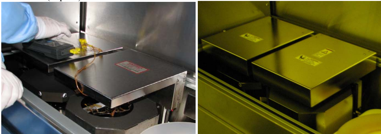
Рис. 1. Горячая и холодная плиты установок SITE CBC и TRATRIX
