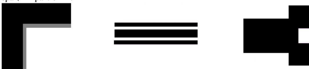
Рис. 1. Типы ОРС фигур (слева направо: bias, assist line, serif)
