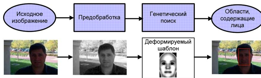
Рис. 1. Общая схема предлагаемого метода
