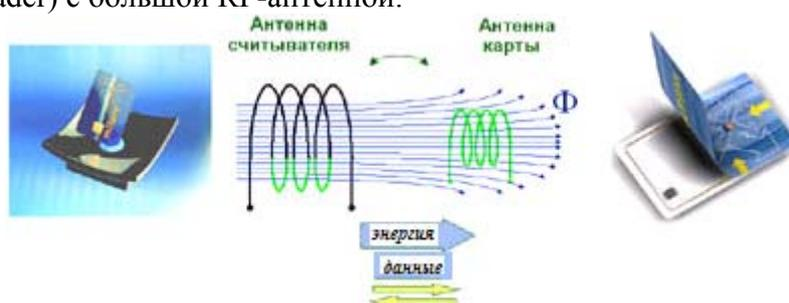
Рис.1. Принцип работы RFID-систем.
