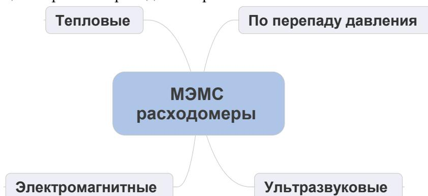
Рис.1. Классификация МЭМС расходомеров по физическим принципам работы.
