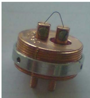
Рис. 2. Фотография катодного узла (катодная ножка с дужкой-держателем углеродного волокна).
