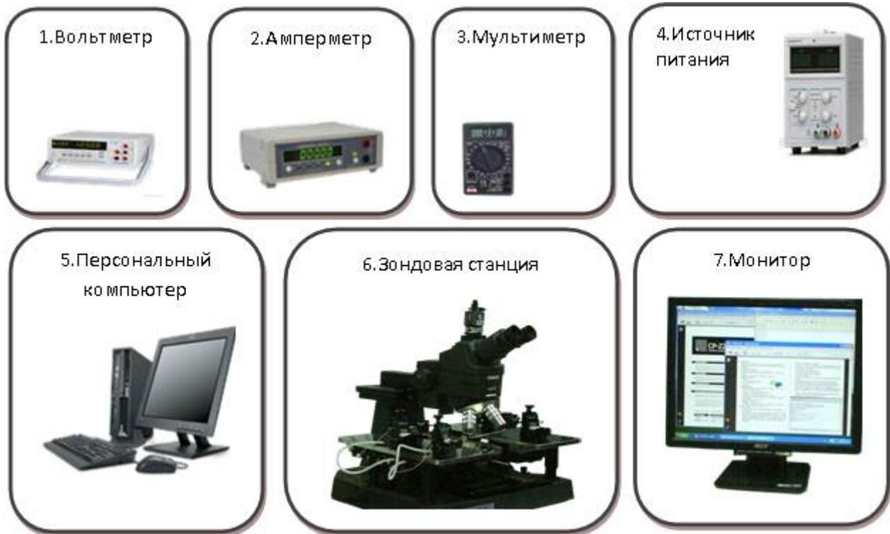
Рис.1. Состав измерительного комплекса.
