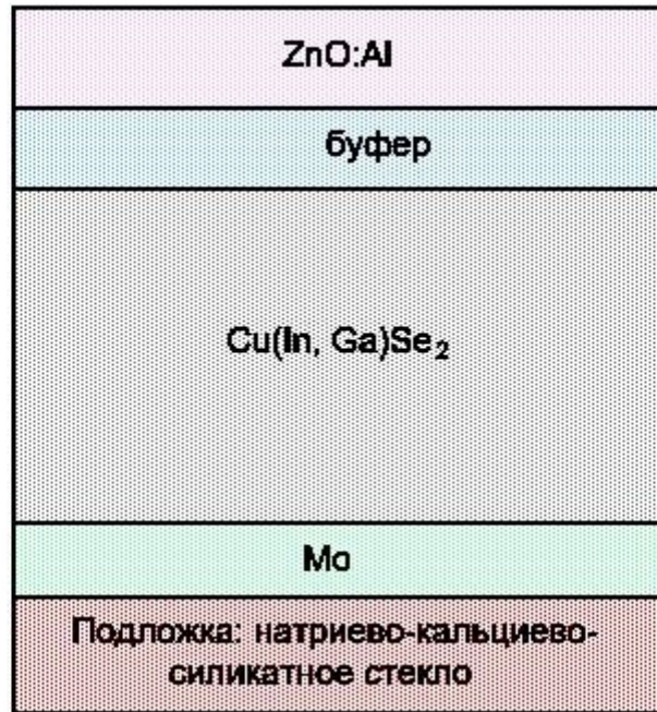
Рисунок 1 – Строение элемента солнечных батарей (1. ZnO:Al, 2. Буферный слой, 3. Cu(In, Ga)Se 2 , 4. Mo, 5. Подложка)
