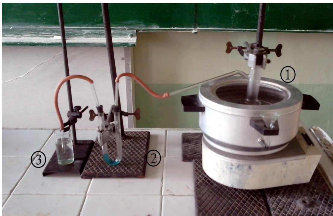
Рисунок 2 – Фотография лабораторная установка для изучения химического связывания газов: 1) колба для получения газа, 2) U-образная трубка, содержащая реагент-поглотитель, 3) контрольный реагент для определения момента насыщения поглотителя.
