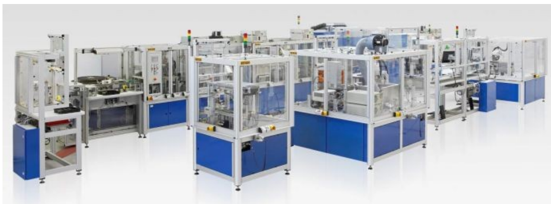
Рисунок 2 – Комплексная производственная линия сборки переключателей для мотоцикла на основе 3D MID [5, 6]
