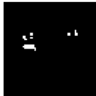
Рисунок 4 - Дефектограмма, полученная в результате распознавания неисправностей по термограмме POST CARD PCI в некорректном режиме функционирования
