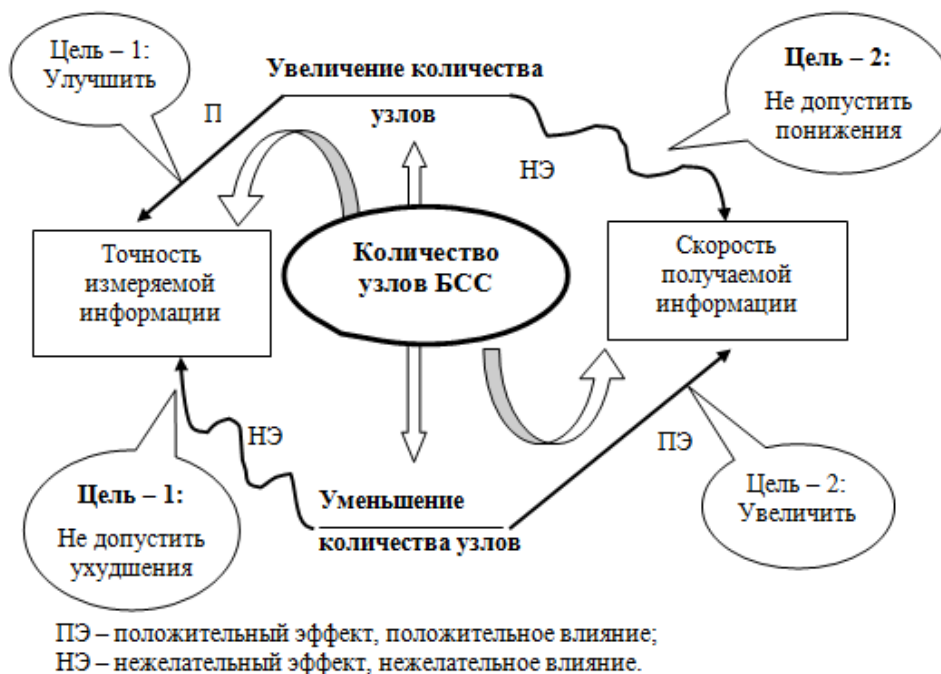
Рисунок 1 – Карта технического противоречия, возникающего при построении БСС
