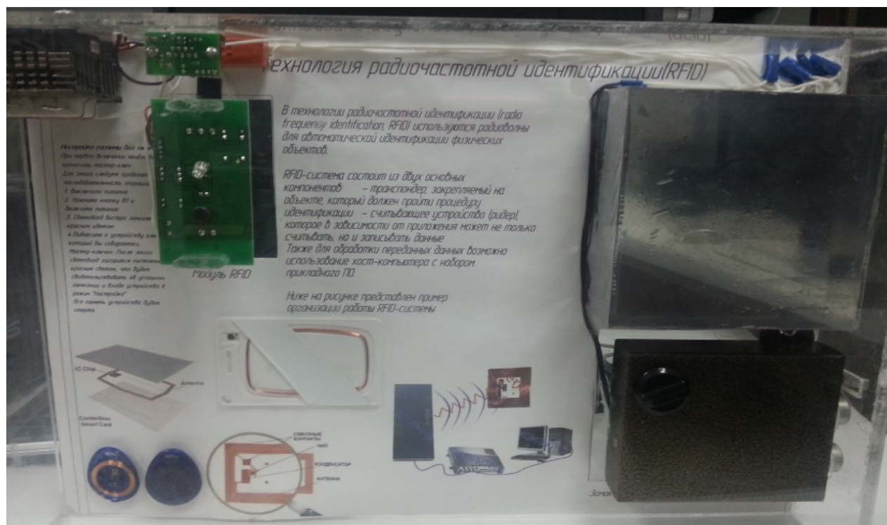
Рисунок 1 – Учебно-лабораторный стенд исследования электромагнитных полей на основе стенда радиочастотной идентификации
