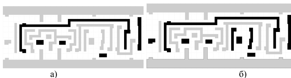
Рисунок 4 – Результат работы алгоритма повышения равномерности плотности распределения полигонов по слоям: а – слой металлизации после декомпозиции, б – слой металлизации после применения алгоритма
