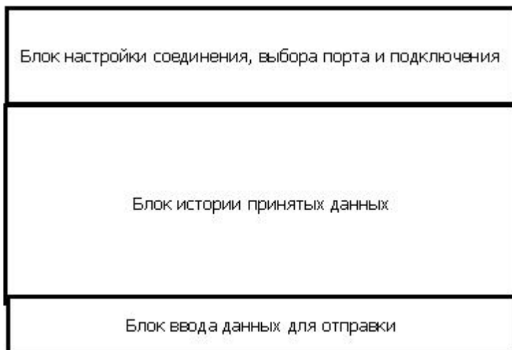
Рисунок 2.1 - Структура интерфейса прототипа кроссплатформенного ПО
