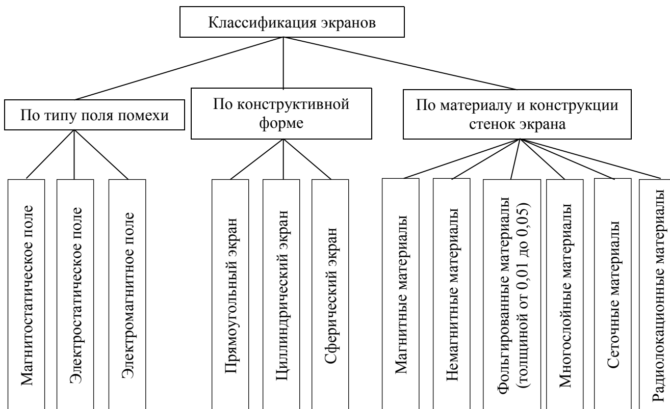
Рисунок 1 – Классификация электромагнитных экранов
