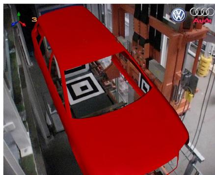
Рисунок 2 – Использование дополненной реальности для проектирования производства
