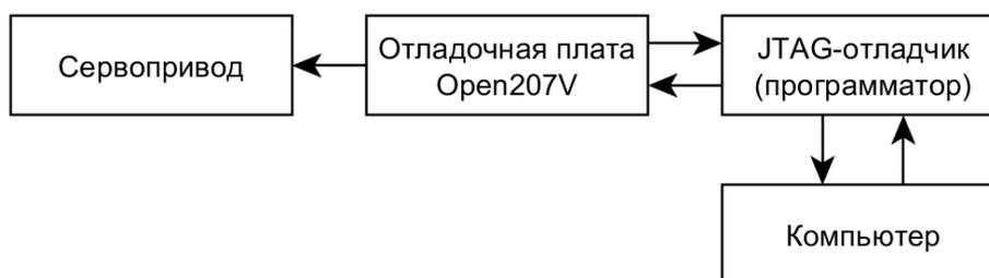
Рисунок 1 – Структура испытательного стенда для системы управления сервоприводом
