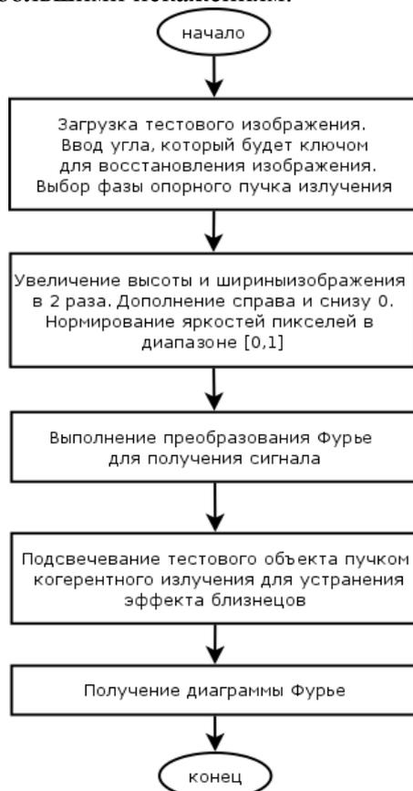
Рисунок 1 - Алгоритм синтеза цифровой Фурье-голограммы
