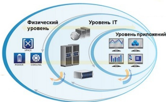
Рисунок 2 – Субмодули архитектуры систем мониторинга ЦОД.
