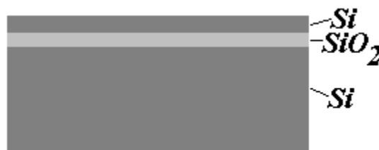
Рисунок 1 – Подложка на основе КНИ-структуры
