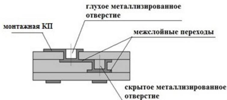
Рисунок 4 - Формирование межсоединений с помощью несоосных микропереходов
