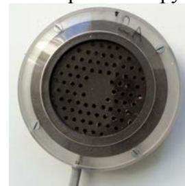
Рисунок 6 - Квази-воздухоэквивалентная ионизационная камера для мониторинга дозы и мощности дозы рентгенотерапевтических аппаратов с анодными напряжениями от 10 до 300 кВ
