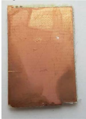
Рисунок 10 - Плёнка, полученная при осаждении полистирола
