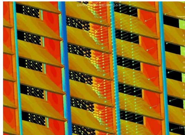
Рисунок 4 - Распределение температуры на поверхности вентиляционной решетки и воздушный поток через нее в среднем сечении (фрагмент, вентиляционная решетка с 6 ребрами жесткости  $\Delta = 3$  мм,  $T_{amb} = -30$  °C)
