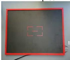
Рисунок 5 - Ионизационная камера для мониторинга дозы и мощности дозы рентгенодиагностических аппаратов с анодными напряжениями от 40 до 200 кВ
