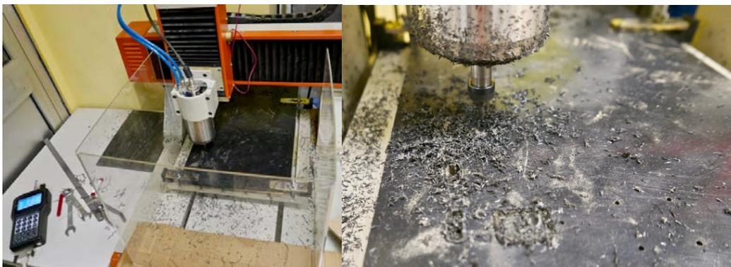
Рисунок 22 – Изготовление деталей на фрезерном станке с ЧПУ
