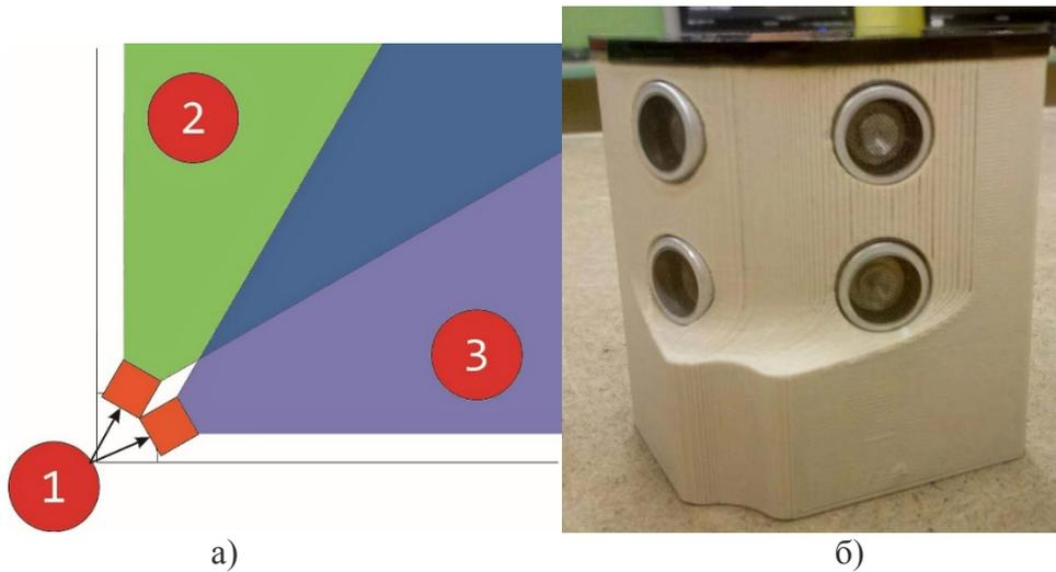
Рисунок 6 – а) Зона покрытия (1 – УЗ излучатели; 2,3 – рабочие зоны излучателя), б) Маяк
