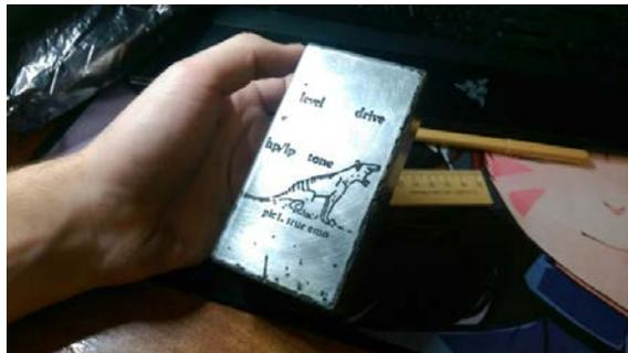
Рисунок 4 – Заготовка после травления
