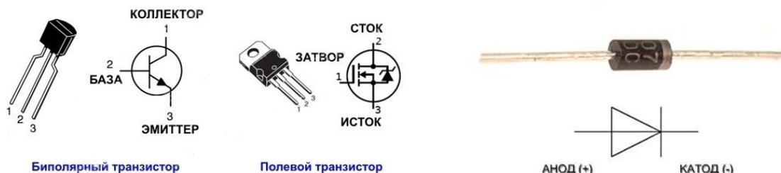
Рисунок 2– Устройство двухполюсника и транзисторов
