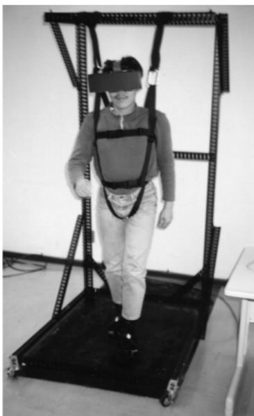
Рисунок 2.1 – Первый прототип Virtual Perambulator
