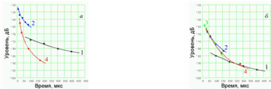
Рисунок 5 - Соотношения уровней сигналов и помех при эхо-импульсном контроле бетона УЗ преобразователями с СТК продольных (а) и поперечных (б) колебаний протектора:
