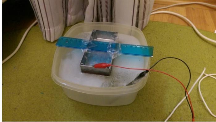
Рисунок 3 – Процесс травления заготовки
