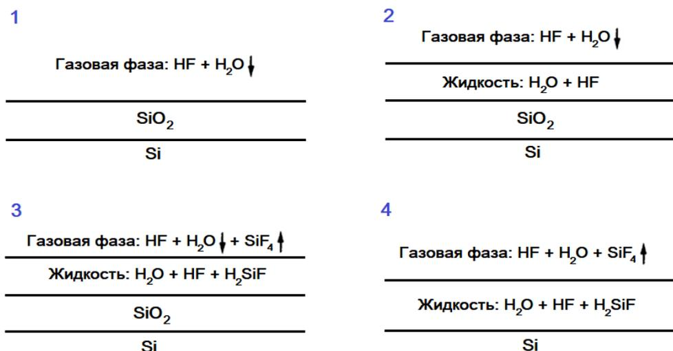
Рисунок 5 – Схематичная диаграмма различных этапов процесса травления в парах плавиковой кислоты [4]
