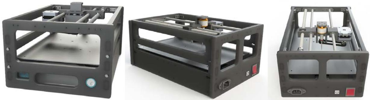
Рисунок 31 – внешний вид разработанного фрезерного станка с ЧПУ
