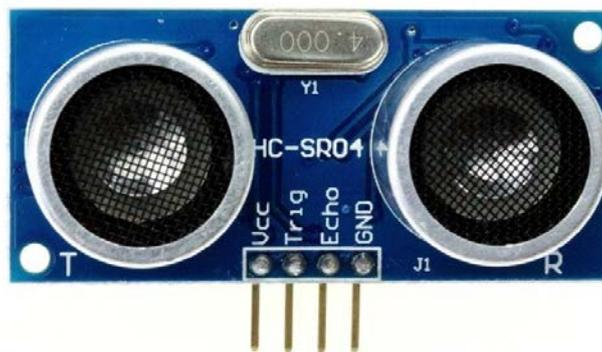
Рисунок 5 - Внешний вид ультразвукового дальномера HC-SR04
