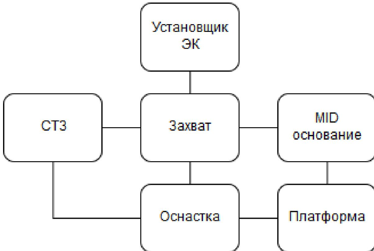
Рисунок 2 – Структурная схема роботизированного комплекса
