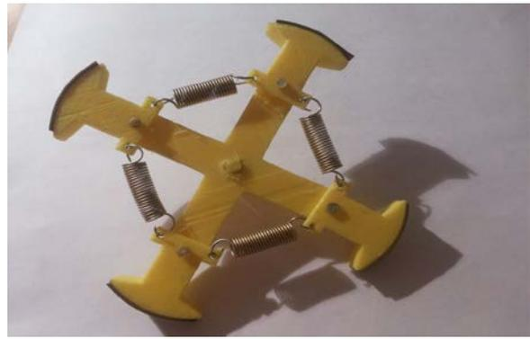
Рисунок 6 – Вариант конструктивного исполнения колеса с изменяемой геометрией
