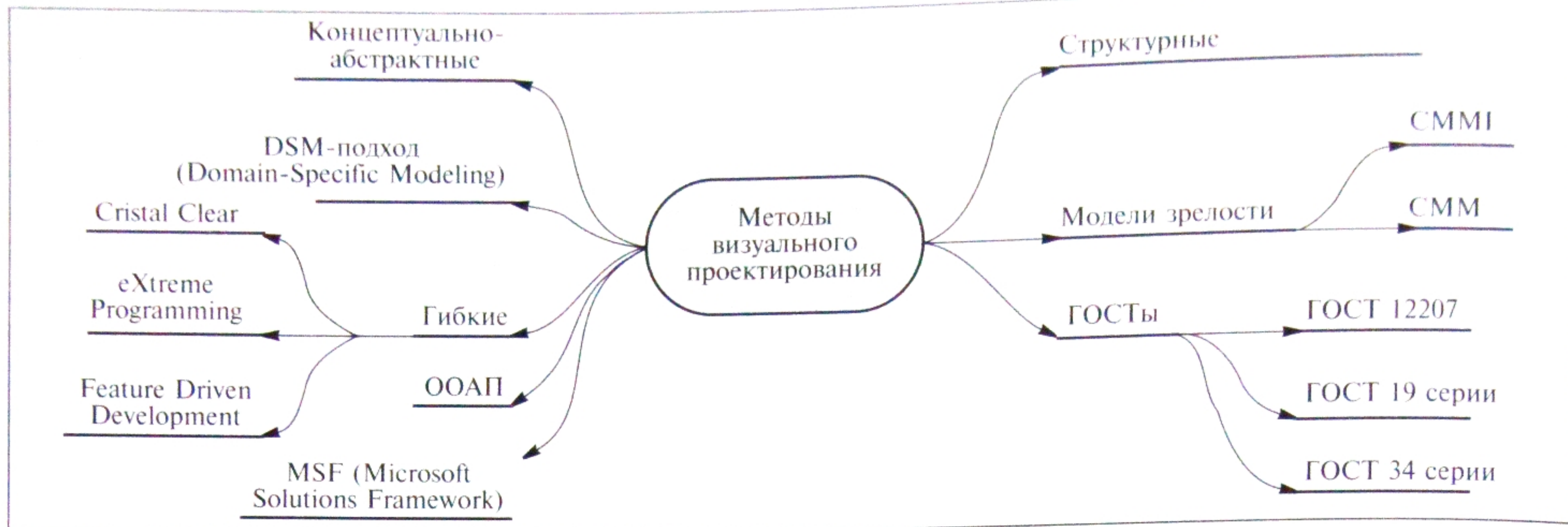
Рис. 2. Основные методы визуального проектирования сложных систем
