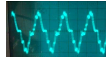
Сигнал на выходе трансформатора
