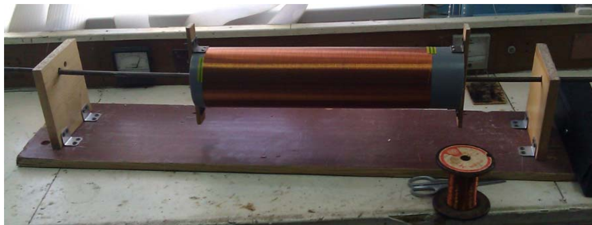
Самодельный намоточный станок
