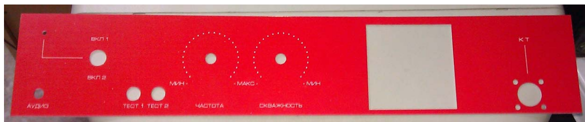
Фальшпанель, изготовленная на системе лазерной гравировки TROFTEC Speedy 100R
