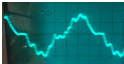
Сигнал на выходе трансформатора
