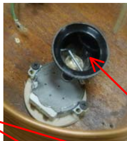
Электромеханический привод: редуктор, двигатель, воронка
