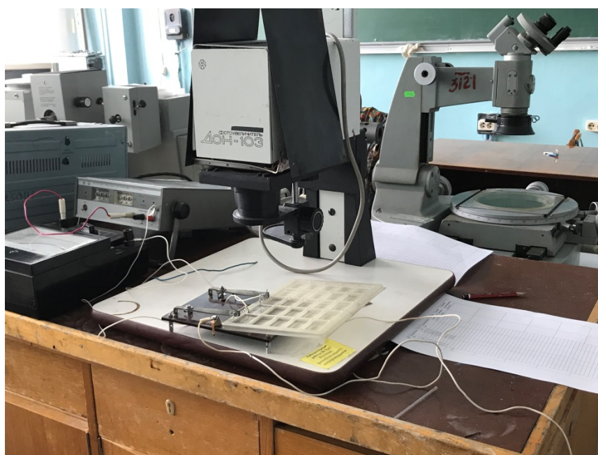
Рис. 11. Установка для определения электрического сопротивления образцов.
