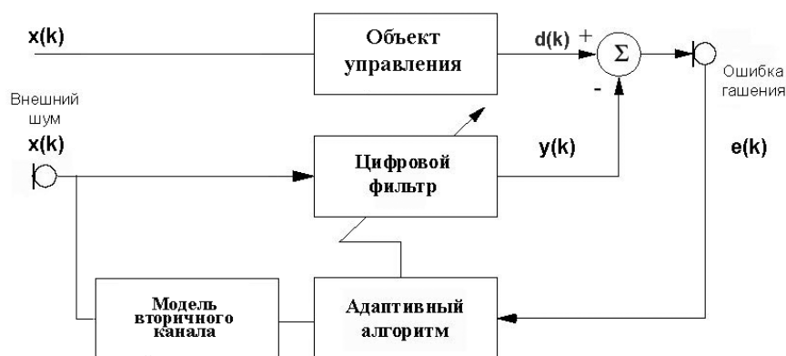
Рис. 3. Структура блока управления адаптивной САГ с моделью передаточной функции объекта управления
