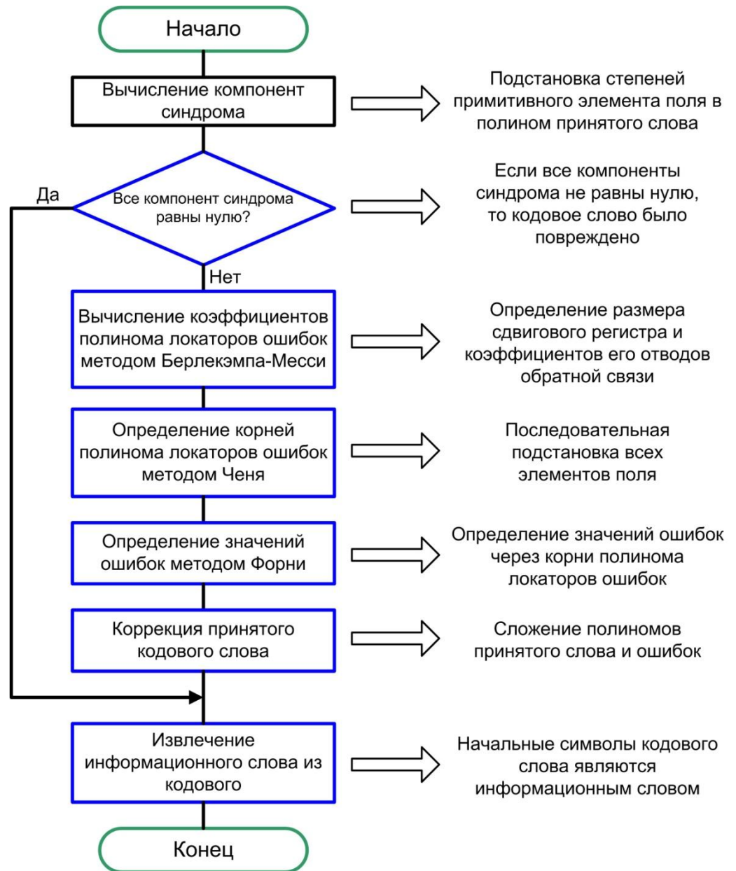
Алгоритм работы декодера кода Рида-Соломона
