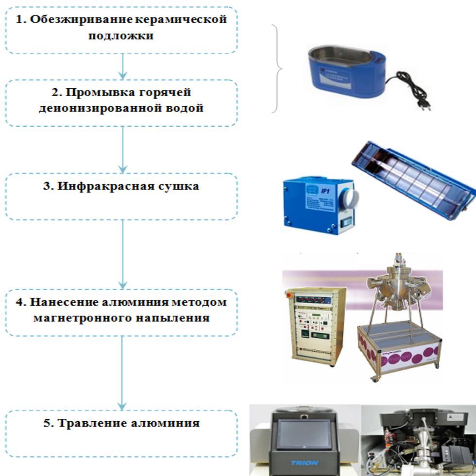
Рисунок 5 – Технологический стенд изготовления тонкопленочной антенны
