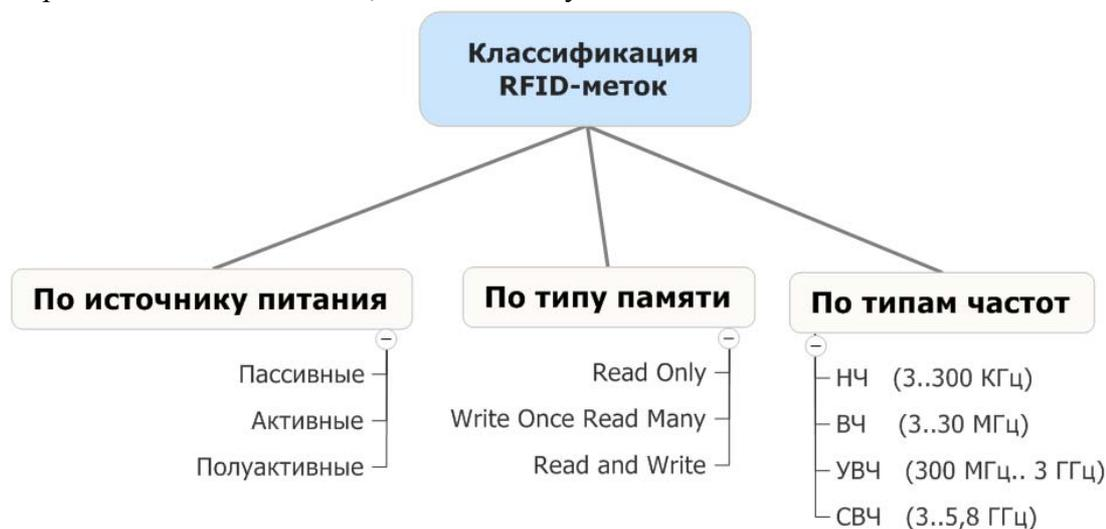
Рисунок 1 - Классификация RFID-меток (НЧ – низкие частоты, ВЧ – высокие частоты, УВЧ – ультравысокие частоты, СВЧ – сверхвысокие частоты)
