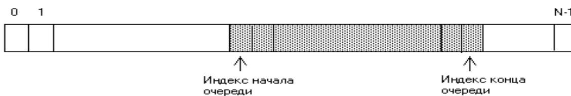
Рис. 3.4 Очередь на базе массива.
