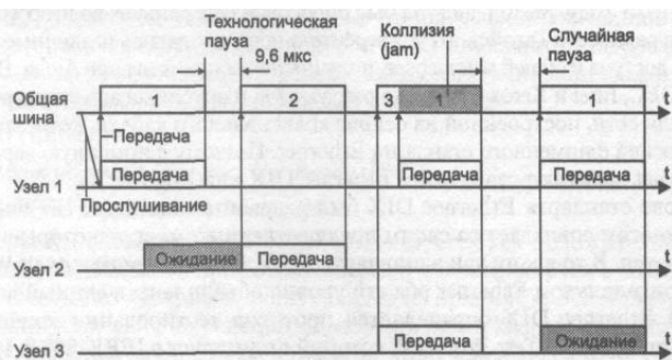
Рис. 3.3. Метод случайного доступа CSMA/CD
