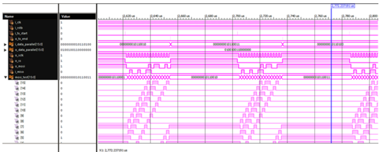
Рисунок 8.8 – Временная диаграмма работы SPI на языке VHDL
