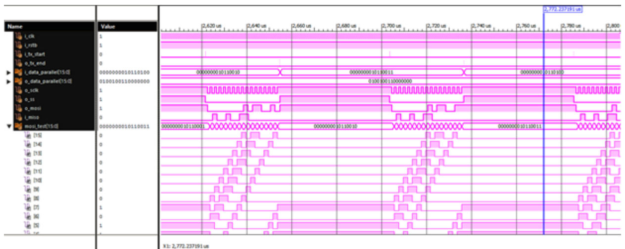
Рисунок 8.7 – Временная диаграмма работы SPI на языке Verilog
