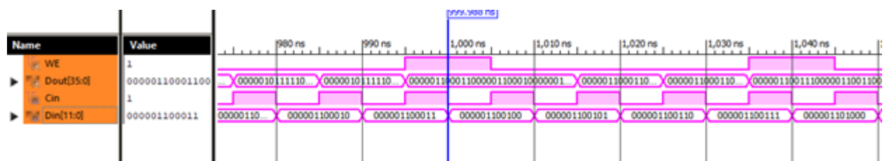
Рисунок 6.6.1 Временная диаграмма работы Десериалайзера 12-36 на языке Verilog
