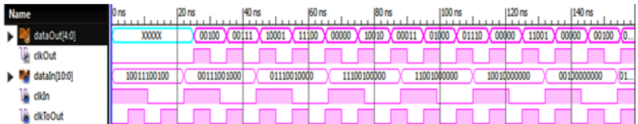
Рисунок 7.4 Временные диаграммы работы Сериализера 11-5 на языке Verilog
