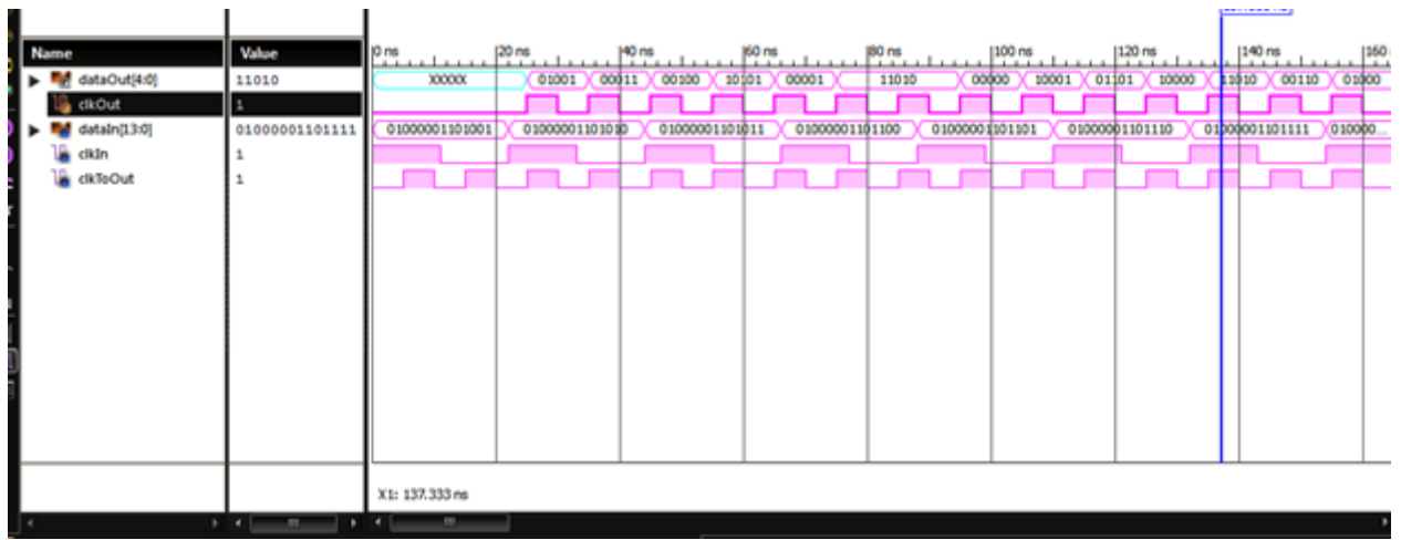
Рисунок 7.8 Временные диаграммы работы Сериализера 14-5 на языке Verilog
