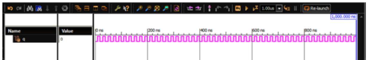
Рисунок 2.1.1 Временная диаграмма работы Генератора VHDL
