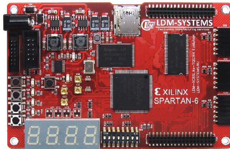
Рисунок 11.1.2 – Отладочная плата XB-XC6SLXx-TQ144 Evolution
