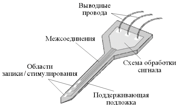
Рис. 1.158. Базовая структура многоэлектродного микрозонда для записи и/или стимулирования ЦНС
