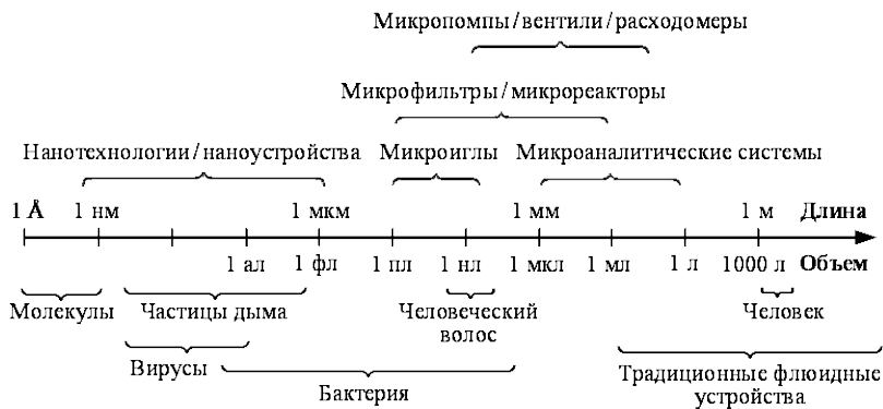
Рис. 1.67. Размерности и масштабы некоторых микрофлюидных устройств
