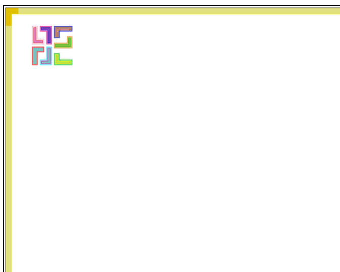
Рисунок 8.2 – Расположение знаков совмещения на кристалле
