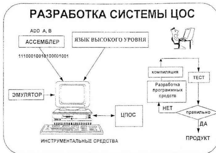
Рис.3.2. Обобщенная схема разработки ЦОС
