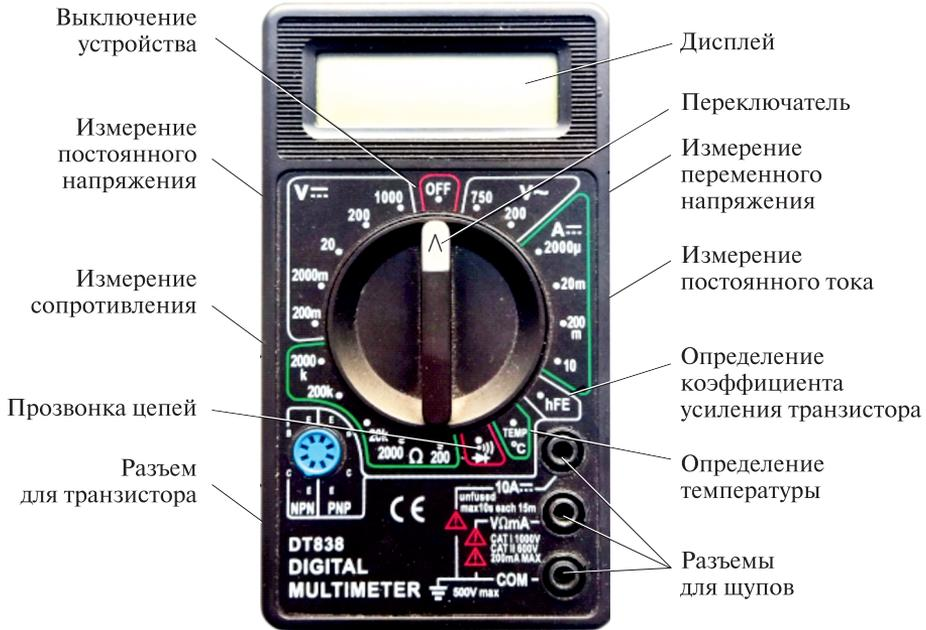
Рис. 1.17. Общий вид цифрового мультиметра
