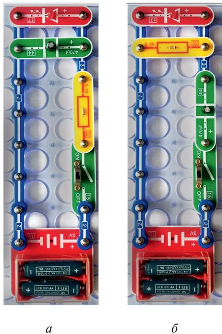
Рис. Л6.6. Общий вид электрической схемы ФНЧ (а) и ФВЧ (б)
