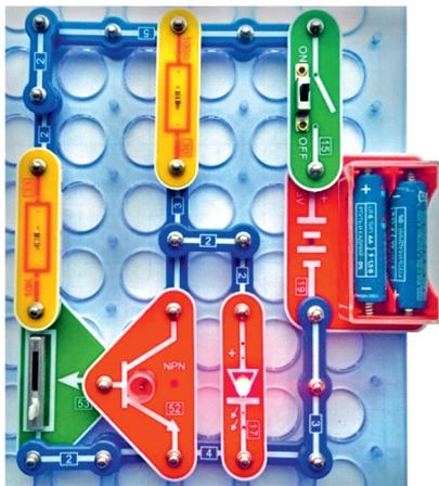
Рис. Л8.15. Вид схемы с общим эмиттером на  $n-p-n$ -транзисторе
