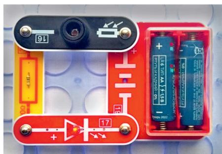
Рис. Л8.7. Общий вид электрической схемы без транзистора
