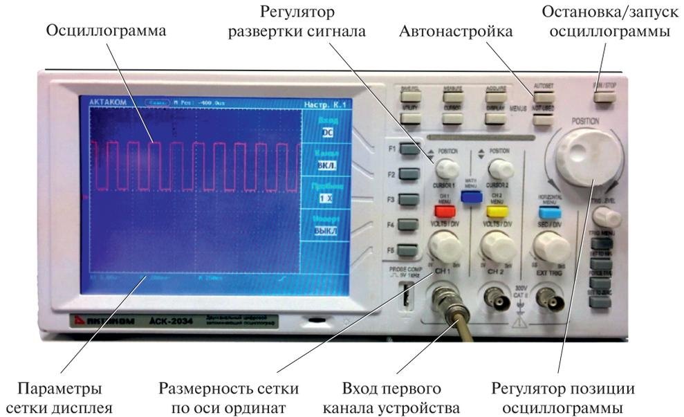
**Рис. Л4.3.** Лицевая панель цифрового осциллографа
