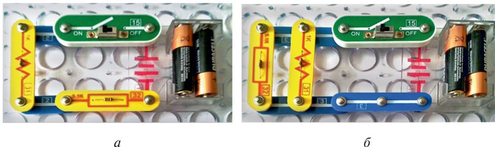
Рис. Л5.5. Общий вид электрической схемы подключения резисторов:
