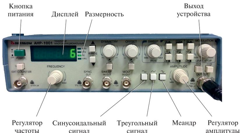
Рис. Л4.2. Лицевая панель генератора сигналов
