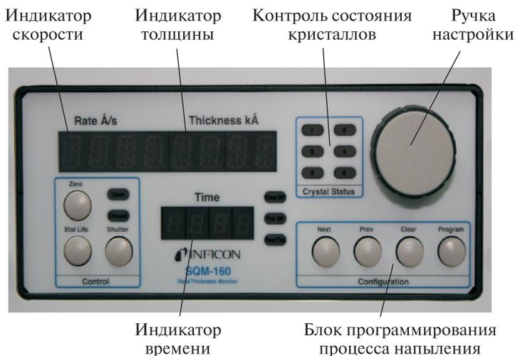
Рис. П5.12. Измеритель толщины и скорости напыления пленок
