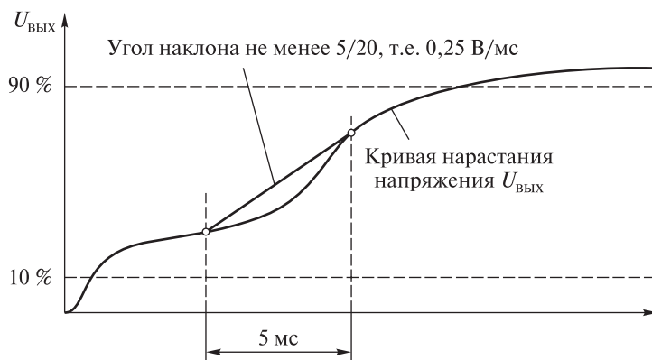
Рис. 1.175. Максимальная скорость нарастания выходных напряжений в канале +5V на пятимиллисекундном интервале
