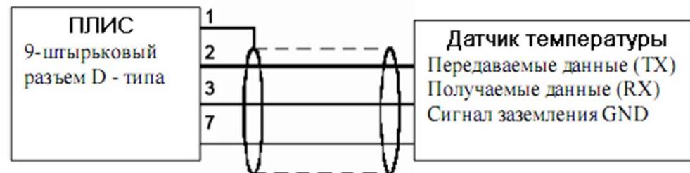
Рис. 12 Схема соединения ПЛИС с датчиком
