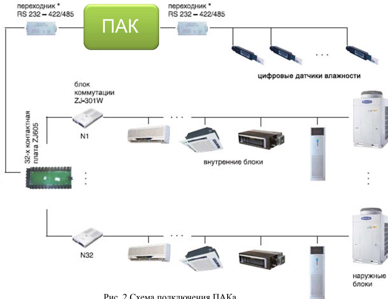
Рис. 2 Схема подключения ПАКа
