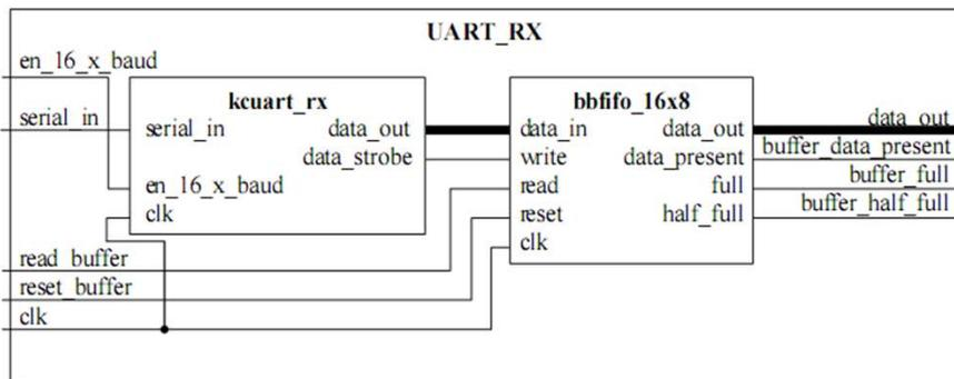
Рис. 5 Схема модуля приёма данных
