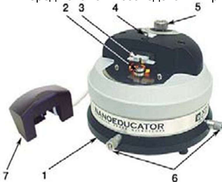
Внешний вид измерительной головки СЗМ NanoEducator
