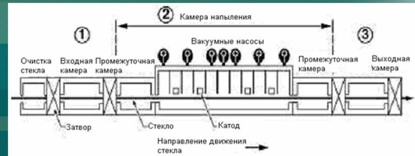
Схема магнетронного напыления в вакууме
