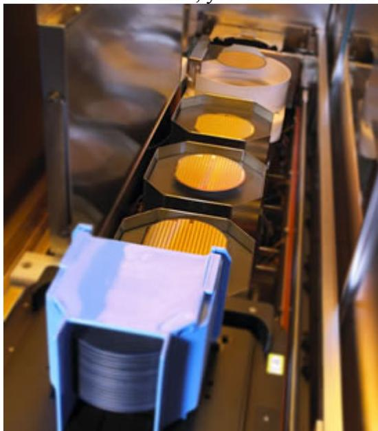
Рис. 1а. Установка для нанесения ФР SITE
