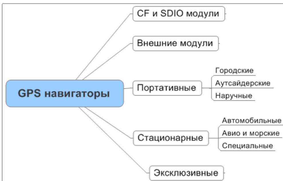
Рис.2.1. Классификация GPS навигаторов по типу конструкции
