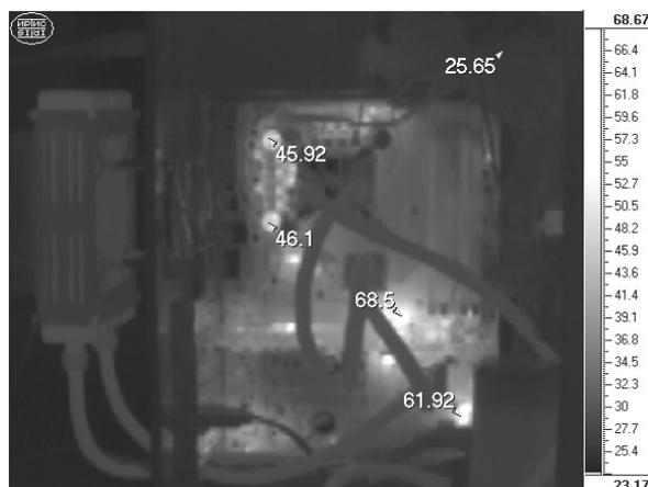
Рисунок 3. Полученная в лаборатории кафедры ИУ4 МГТУ им. Н. Э. Баумана термограмма форсированной компьютерной системы с жидкостным охлаждением, наглядно отражающая перегрев микросхем памяти видеокарты
