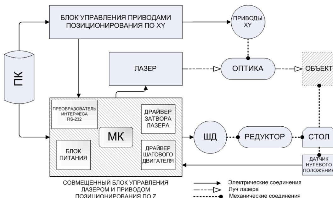
Рис.2. Структурная схема одноканального варианта установки формирования 3D изображений.
