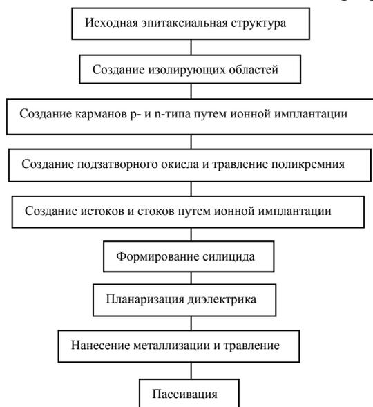
Рис. 1. Технологический маршрут изготовления КМОП-структур
