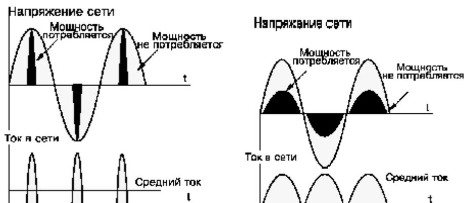
Рис. 1. Ток и мощность, потребляемые источником питания без коррекции и с коррекцией коэффициента мощности
