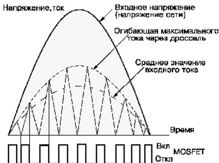
Рис. 3. Временные диаграммы работы корректора коэффициента мощности
