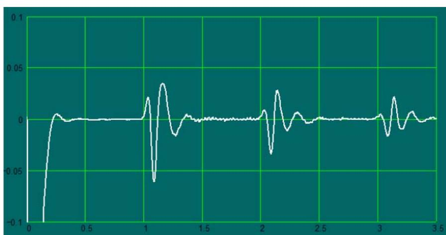
Рис. 1 Осциллограмма эхо-сигналов в свободном анкерном болте.
