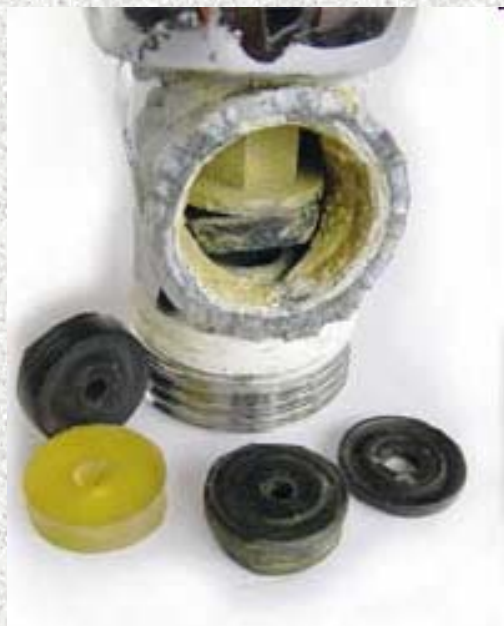
Уплотнение производится резиновыми прокладками
