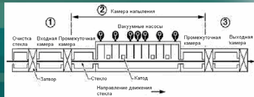
Схема магнетронного напыления в вакууме
