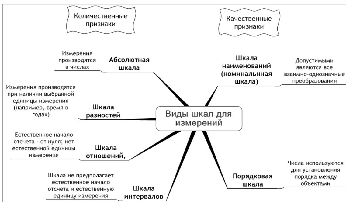
Рис.В.8. Классификация шкал измерения.
