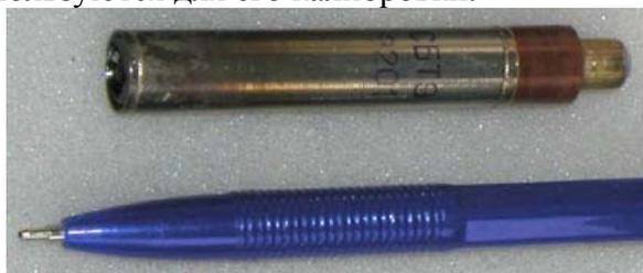
Рисунок 4 – Внешний вид ионизационной камеры
