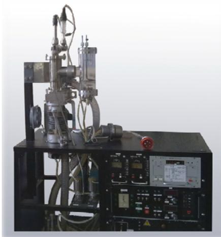
Рисунок 1 - Малогабаритная вакуумная установка модульного типа
