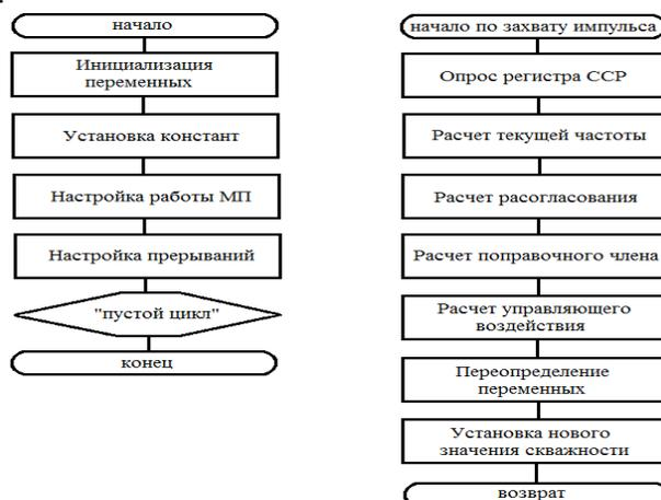
Рисунок 2 – Алгоритм работы микропроцессорной системы
