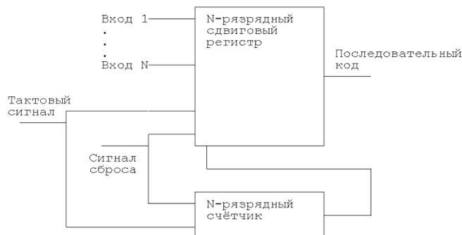
Рисунок 2 – структурная схема преобразователя параллельного кода в последовательный
