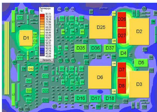
Сеточная 2D модель распределения температурных полей на плате.
