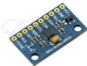
Рисунок 3 – Девятиосевой MEMS-датчик ориентации MPU-9250A на отладочной плате
