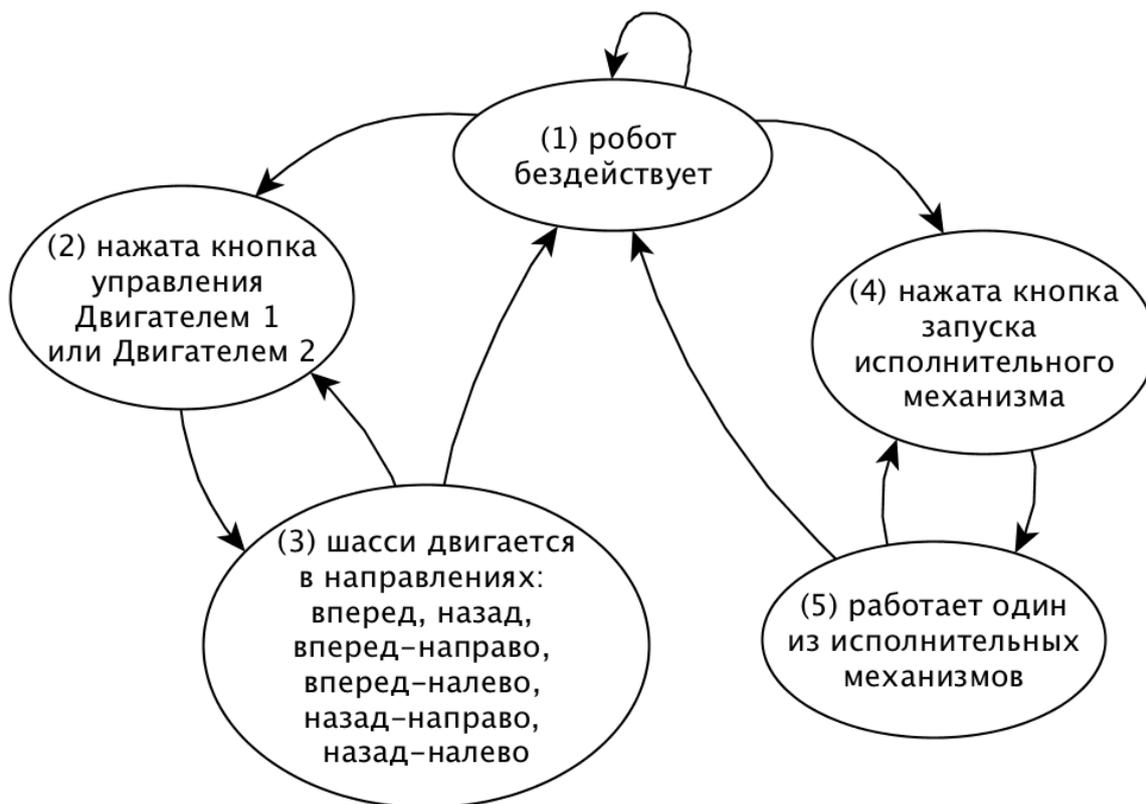
Рисунок 9 – Машина состояний мобильного робота с исполнительными механизмами
