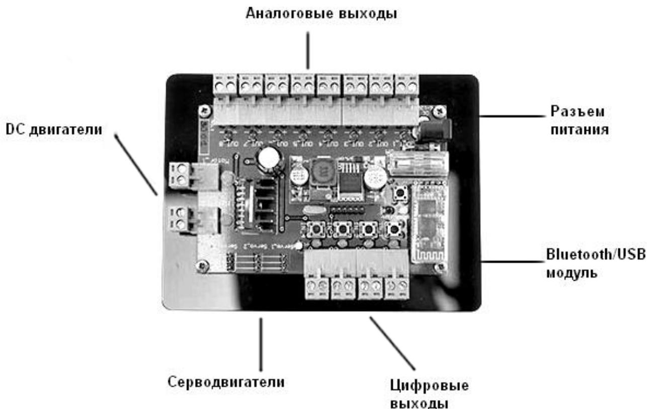
Рисунок 11 – Структурно-функциональная схема Oktopod\_Board
