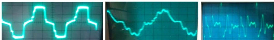
Рисунок 4 – Первоначальная схема блока управления трансформатором Тесла (с полумостовым инвертором и трансформаторной развязкой): сигналы на выходе управляющей части, трансформатора, инвертора
