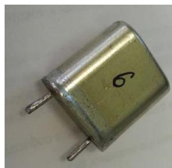
Рисунок 5 – Резонатор с  $f=12,797\text{МГц}$
