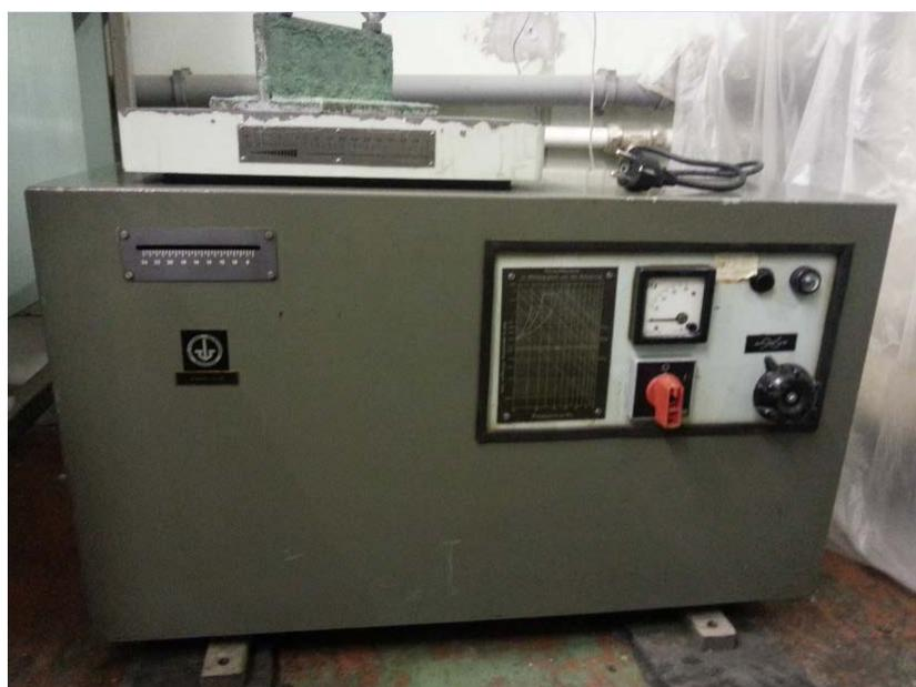
Рисунок 2 - Электромеханический вибростенд ST-80
