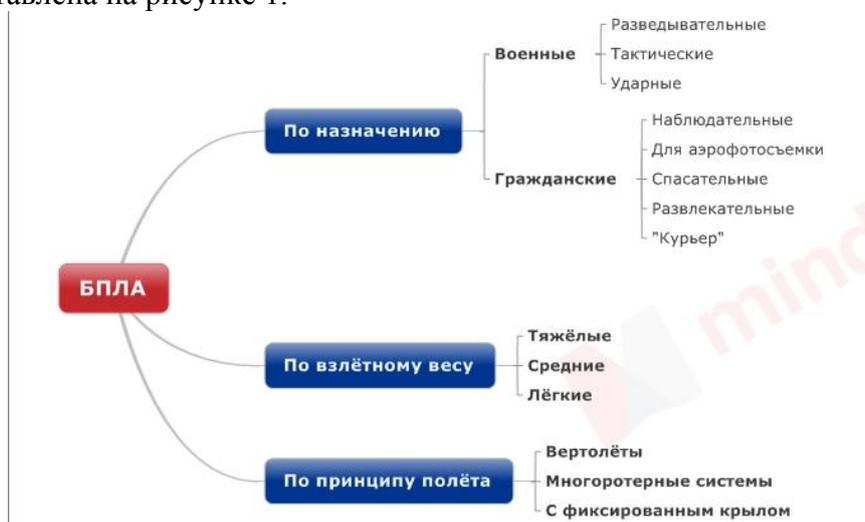
Рисунок 1 – Классификация беспилотных летательных аппаратов
