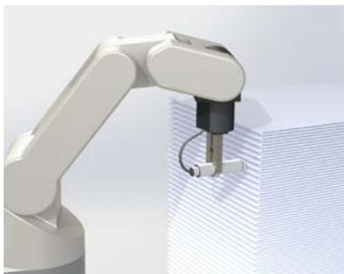
Рисунок 2 - Манипулятор АВУ для контроля сварных швов РЭ
