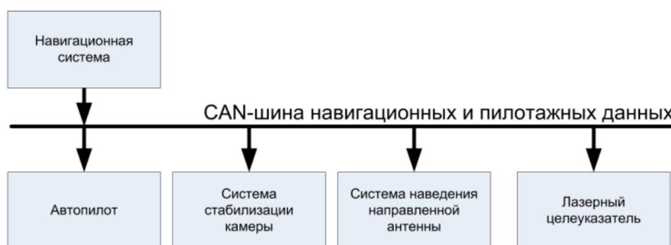
Рисунок 3 – Структурная схема возможных составляющих БРЭО
