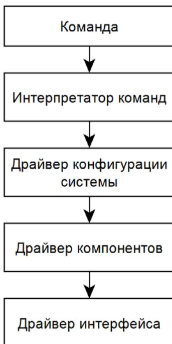
Рисунок 3 – Структура программы обработки команд
