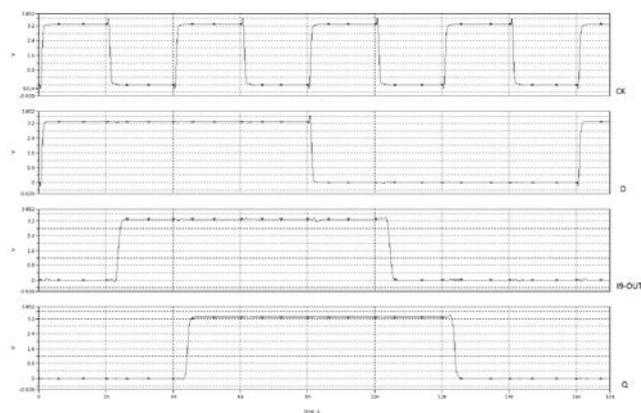
Рисунок 9 – Временные диаграммы триггера при отсутствии воздействия,  $D=4CK$
