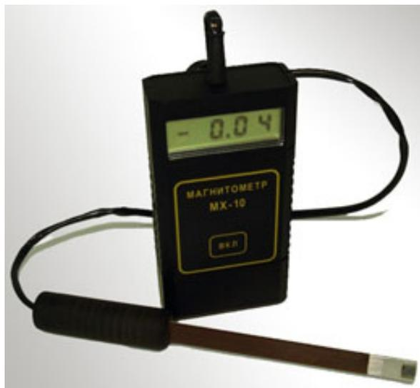
Рисунок 1 - Внешний вид магнитометра МХ-10
