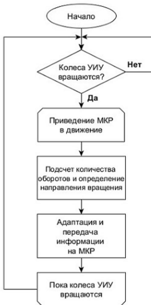
Рисунок 3 – Алгоритм работы системы управления шасси
