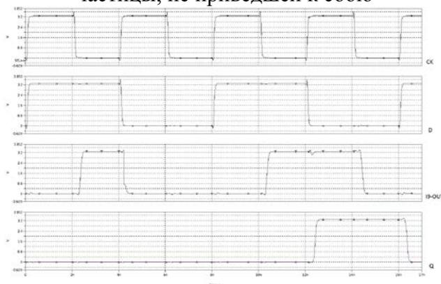
Рисунок 12 – Временные диаграммы триггера под воздействием тяжелой заряженной частицы иллюстрирующие сбой
