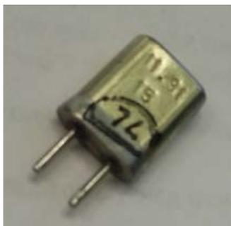
Рисунок 6 – Резонатор с  $f=7,403\text{МГц}$
