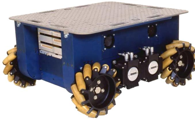
Рисунок 1 – Шасси робототехнической платформы
