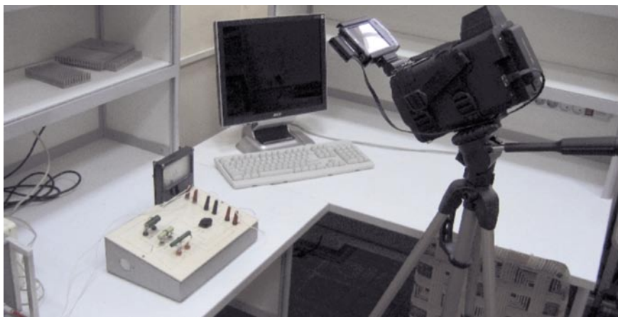
Рис. 9. Стенд для проведения теплового контроля на базе термографа ИРТИС2000
